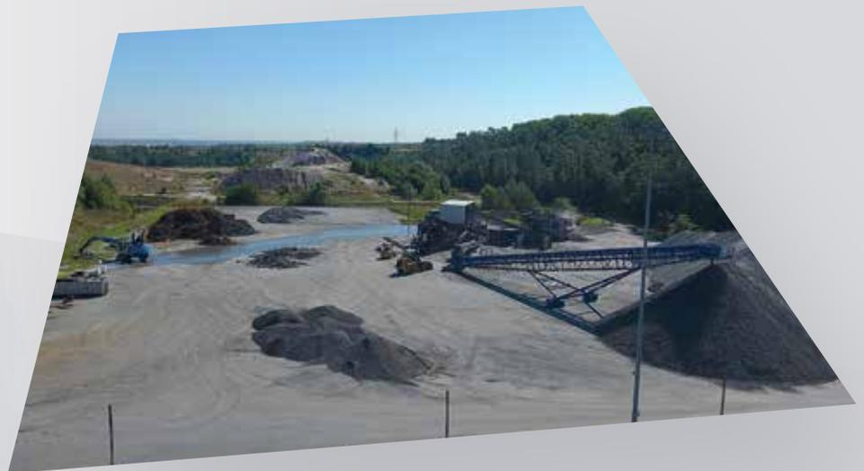
Die Rostasche wird in einer speziellen Anlage aufbereitet. Dabei werden Metalle zur Wiederverwertung aussortiert.
